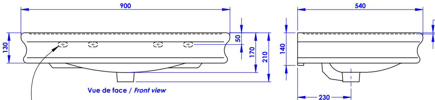
Ø de perçage et entre-axe recommandés.
